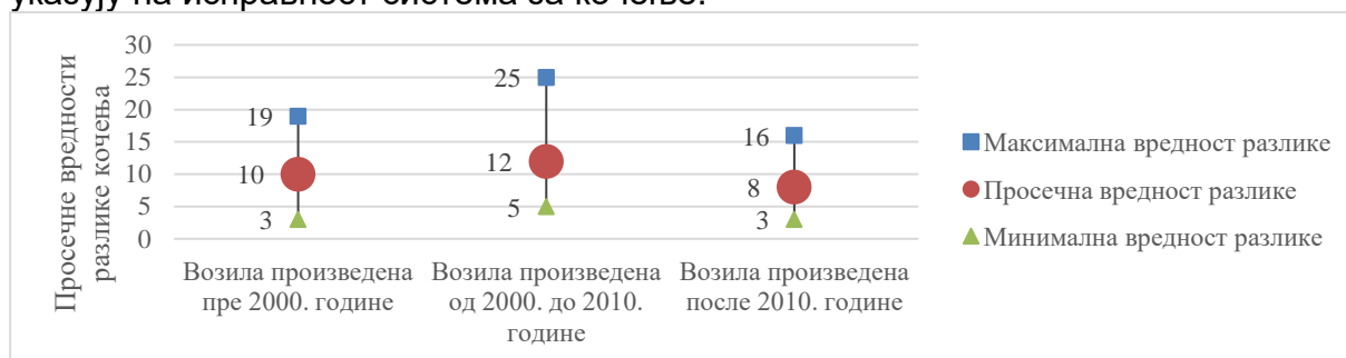
Слика 8. Вредности одступања кочне силе точкова предње осовине за исправна возила
