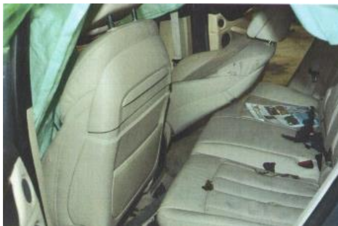
Slika 1. Zatečeni položaji sedišta vozača i suvozača nakon nezgode koji ukazuju da na zadnjem sedištu nije mogla sedeti odrasla osoba
