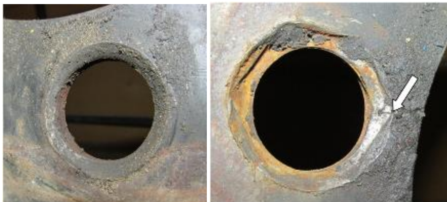
Slika 7. Otvori za vijke. Strelica pokazuje pukotinu
