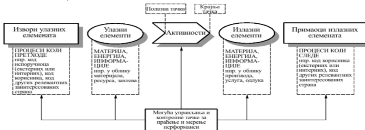
Slika 5. Šematski prikaz elemenata jednog procesa iz standarda SRPS ISO 9001:2015 [20]
