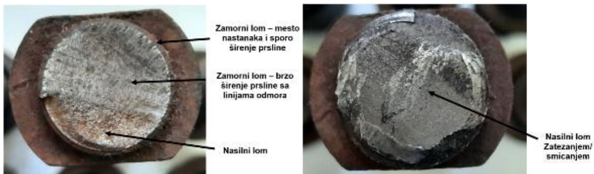
Slika 6. Levo: Zamorni lom vijaka. Desno: Lom usled zatezanja/smicanja
