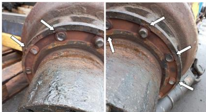
Slika 8. Strelice pokazuju otiske nastale naleganjem naplatka
